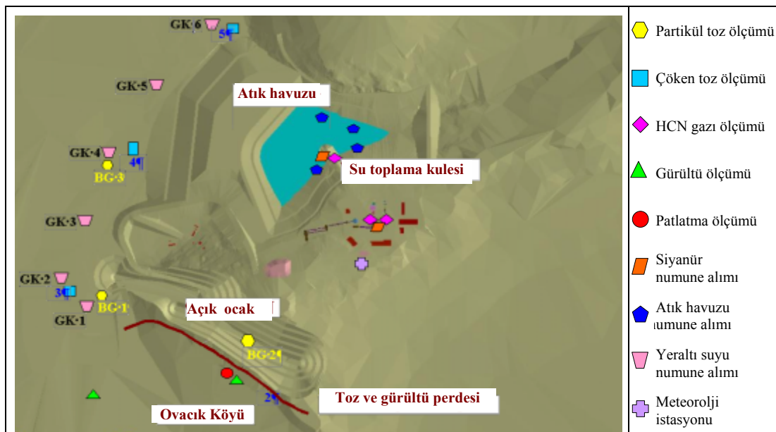
Şekil 1. Ovacık altın madeni çevre koruma ölçüm noktaları
